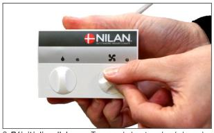
8. **Réinitialiser l'alarme:** Tourner le bouton de réglage de ventilation comme suit :  $\Rightarrow$  0  $\Rightarrow$  4  $\Rightarrow$  0. Tourner le bouton de réglage de ventilation jusqu'à la valeur souhaitée
