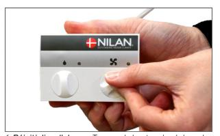
6. **Réinitialiser l'alarme:** Tourner le bouton de réglage de ventilation comme suit :  $\Rightarrow$  0  $\Rightarrow$  4  $\Rightarrow$  0. Tourner le bouton de réglage de ventilation jusqu'à la valeur souhaitée
