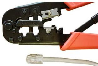
Il est important d'utiliser un outil de rétraction adéquat pour que le connecteur RJ12 soit correctement raccordé au cordon.
