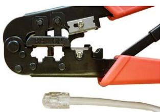
Il est important d'utiliser un outil de rétraction adéquat pour que le connecteur RJ12 soit correctement raccordé au cordon.
