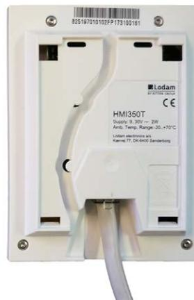
Insérez la prise RJ12 dans son emplacement situé en bas du HMI. Le fil peut suivre le long du mur, dans le mur ou à travers la rainure à l'arrière du panneau.
