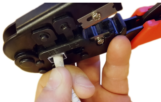
Image 10 Presser le câble dans la prise RJ45 pendant le sertissage
