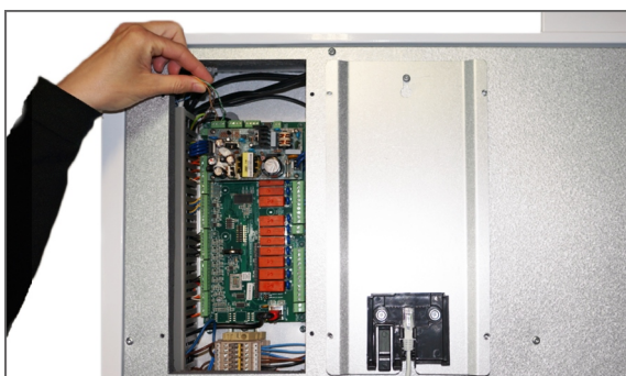
5. Dévissez les câbles connectant l'écran tactile à la carte, démontez les fixations murales et montez-les là où vous souhaitez que l'écran tactile soit accroché.
