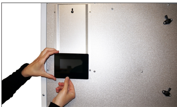
3. Soulevez l'écran tactile en poussant sur le clip de verrouillage situé à sa base.
