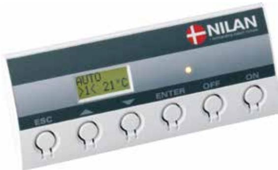
Comfort 450 est commandé par le biais d'un boîtier de commande CTS 602 livré avec l'appareil. La commande propose de nombreuses fonctions via une interface à menus tel que la programmation hebdomadaire, le paramétrage de la périodicité de maintenance, le réglage de la vitesse de ventilation, la fonction bypass pour l'été, la configuration du chauffage additionnel, le journal des alarmes, etc.
