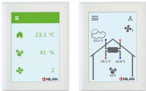
Comfort 300LR est contrôlée par le biais du panneau de commande à écran tactile HMI livré avec la centrale. Le contrôleur propose de nombreuses fonctions tel que la programmation hebdomadaire, le paramétrage de la périodicité de maintenance des filtres, le réglage de la vitesse de ventilation, la fonction bypass pour l'été (« free cooling » rafraîchissement libre), la configuration d'un chauffage additionnel, le journal des alarmes, etc.
