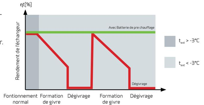
*L'énergie requise par la batterie de préchauffage n'est pas perdue, car elle garantit un rendement de l'échangeur élevé et constant.*
