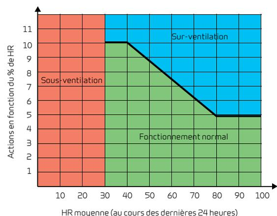
*Si le taux d'humidité varie de plus de 5-10 % par rapport au taux moyen, le système réagit en sur/sous-ventilant.*
